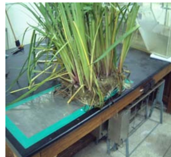
그림 7. 식물을 식재한 식생 콘크리트
